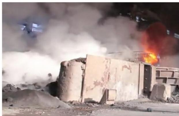
图6 带罐打水法 - 倒渣过程
