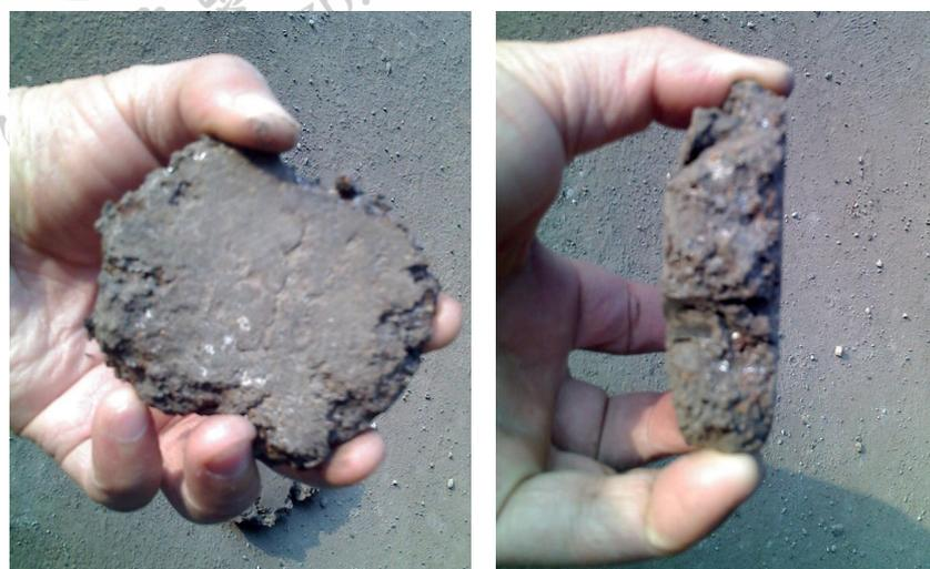
图4 GYP-1200 惯性圆锥破碎机轧扁的渣钢块
