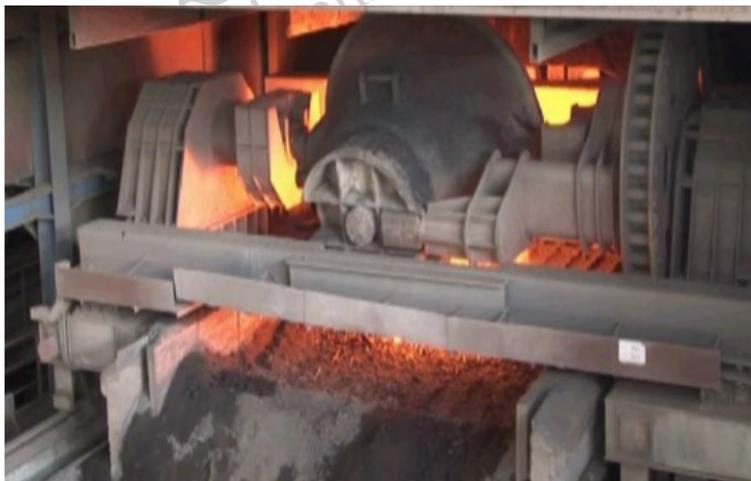
图9 渣罐倾翻机（实现渣罐360度倾翻作业）
