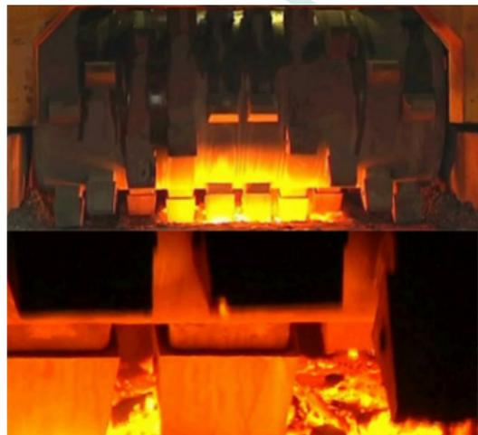
图10 辊压破碎机（实现熔融钢渣快速离散、固化并进行推料）
