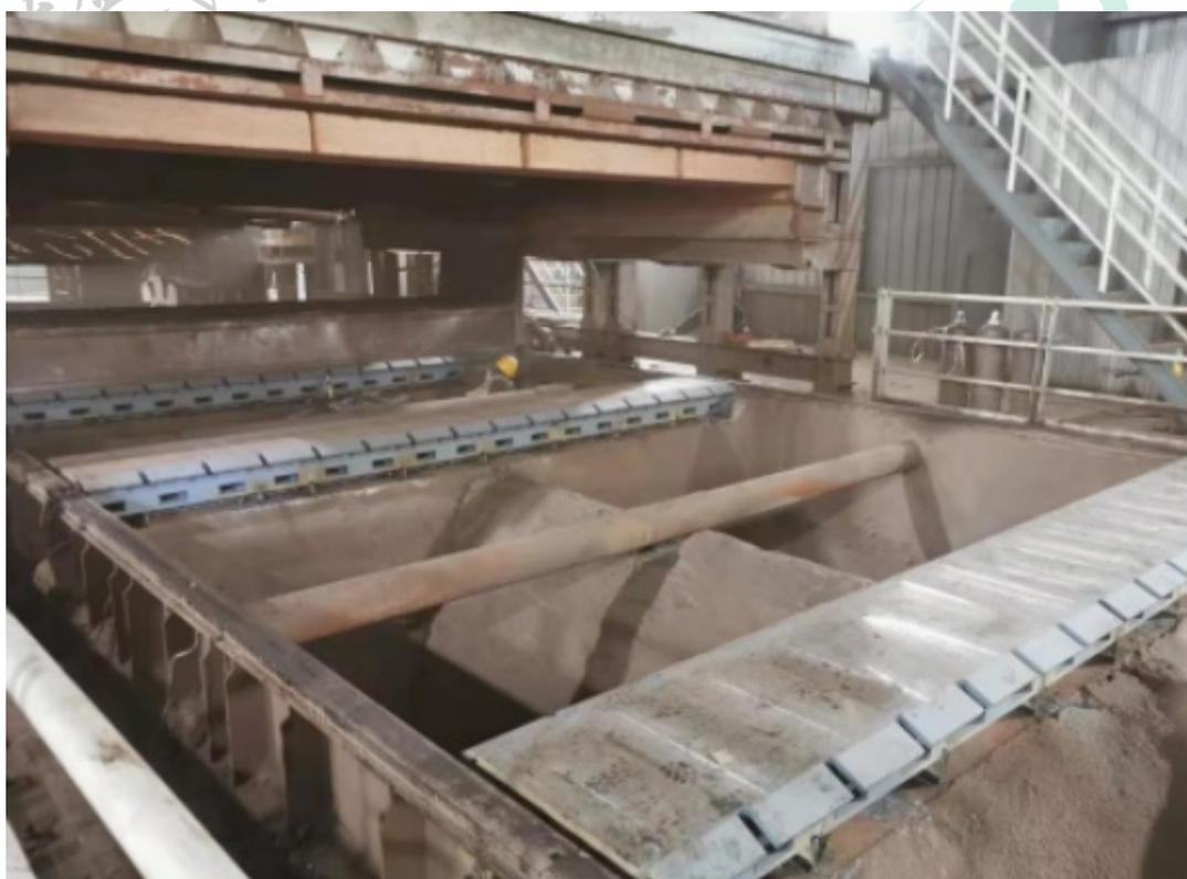
图1 风箱隔板改造
