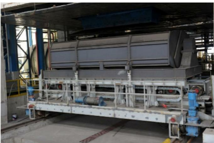
图11 渣槽及其转运台车（实现热渣转运并卸料）
